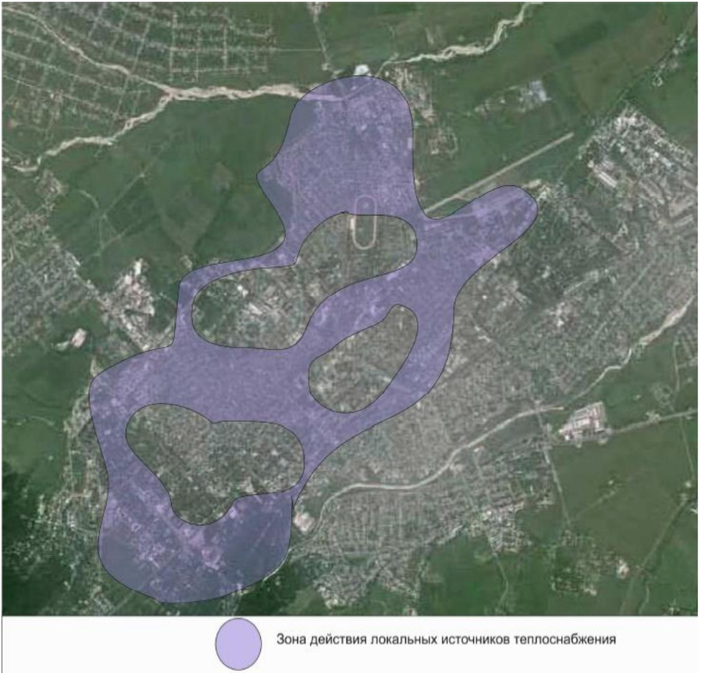
Рис. 2. Зоны действия локальной (индивидуальной) системы теплоснабжения.
